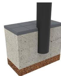
El tratamiento Ferrus se compone de tres capas que se aplican después de limpiar toda la suciedad y las impurezas mediante granallado y consiste en un zincado, seguido de una capa de imprimación epoxi y un último recubrimiento de pintura poliéster en polvo color gris RAL 7016.
